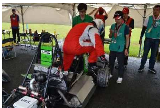
図7 ドライバー脱出試験
