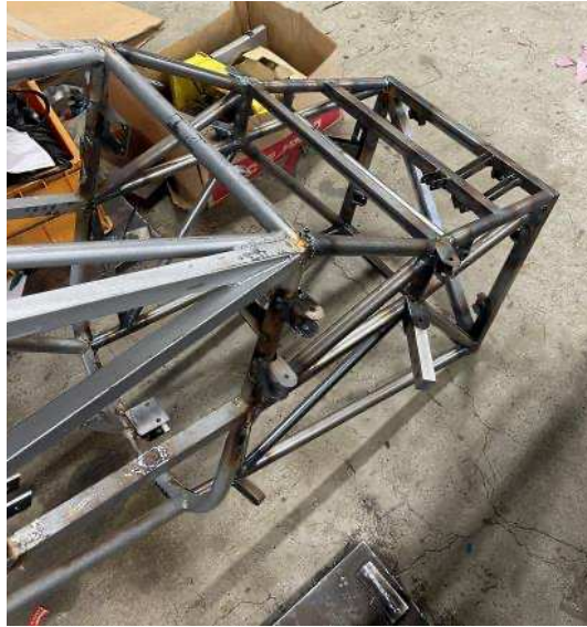
図5 フロントフレームの裏付け（底面から溶接している様子）
